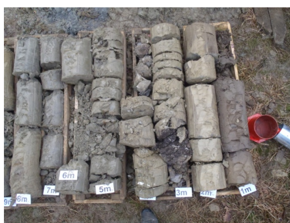
Foto 5: Dokumentace vrtu HV-109 v místě plánovaného železničního tělesa v metráži 0–8 m se smykovou plochou v hloubce 6,4 m.
