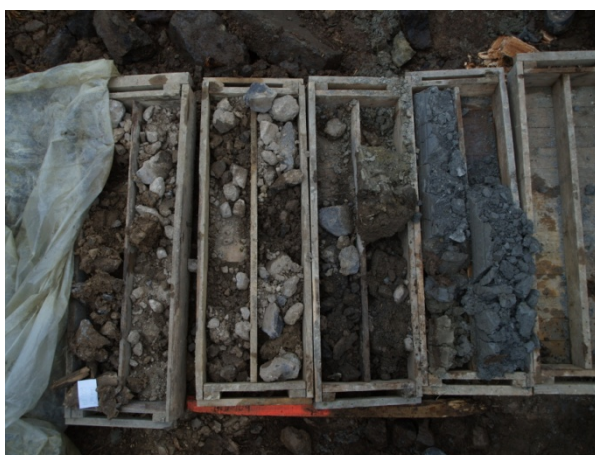
Foto 5: Dokumentace vrtu HV-109 v místě plánovaného železničního tělesa v metráži 0–8 m se smykovou plochou v hloubce 6,4 m.
